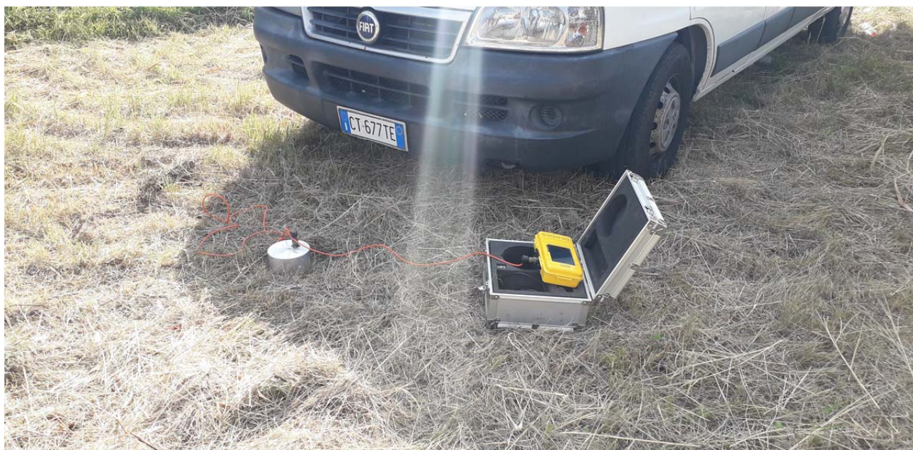
Figura 3 - Ubicazione misura di microtremori a stazione singola (HVSr, H/V).
